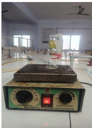
Image-4: Franz Diffusion Cell Apparatus
